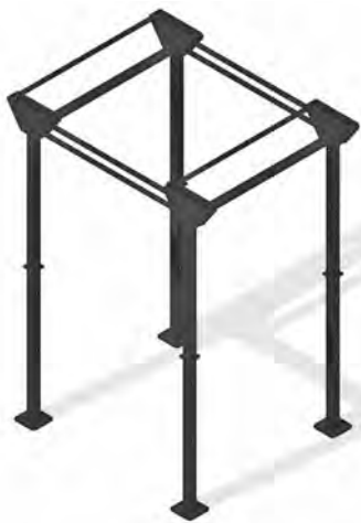
4 Т-стойки с верхними элементами и W-соединителями
